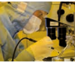
Auszubildende beim Stapeln von Laserstacks im Reinraum des Ferdinand-Braun-Instituts.
