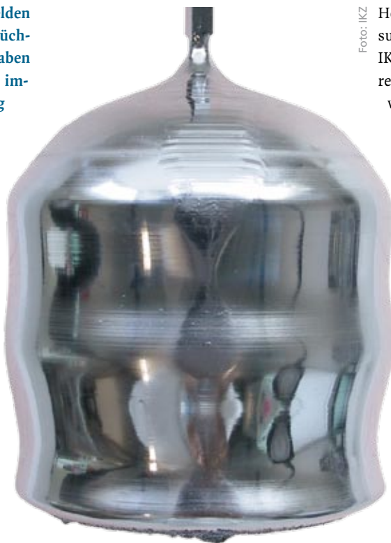
GaAs-VCz-Kristall, gezogen aus Galliumreicher Schmelze ohne Boroxid. Das Bild zeigt den Kristall etwa in Originalgröße.
