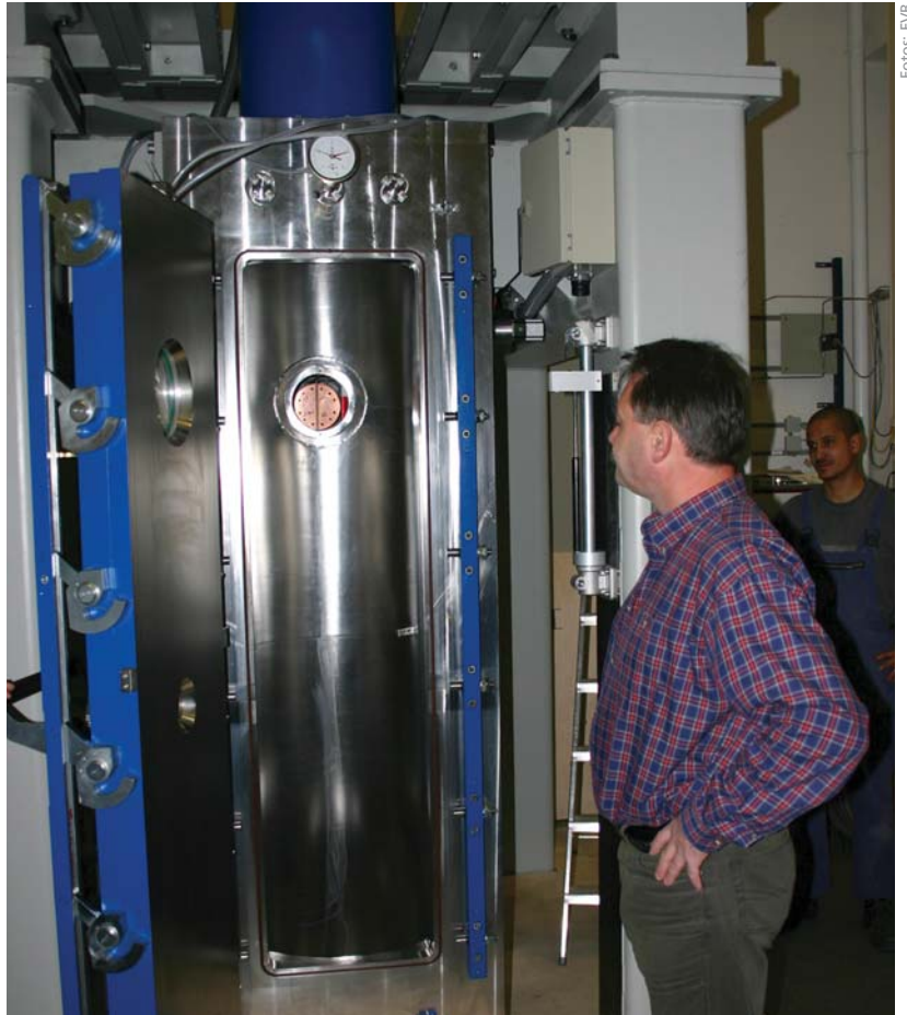
An der Fertigstellung dieser Maschine arbeiten die Experten des IKZ gerade. Ralph-Peter Lange hat die Stahltür der Züchtungskammer geöffnet.
