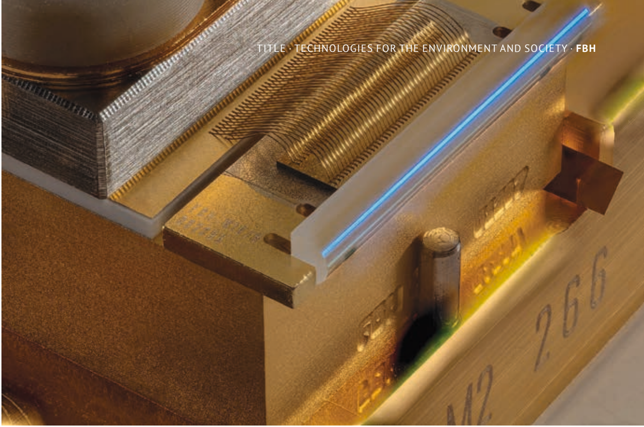
Laserdiodenbank aus dem Ferdinand-Braun-Institut vor dem Einbau in das Pumpmodul.
