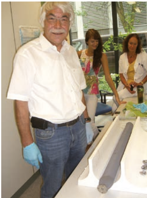
Auf dem Weg zum künftigen Urkilogramm: Prof. Dr. Manfred Peters von der Physikalisch-Technischen Bundesanstalt steht im Leibniz-Institut für Kristallzüchtung vor dem hochreinen Ausgangsmaterial aus Silizium-28. Daraus wollen die IKZ-Mitarbeiter einen makellosen Einkristall für das künftige Urkilogramm züchten.
